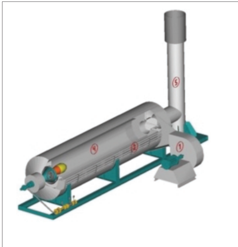
Esquema funcionament oxidació tèrmica recuperativa
