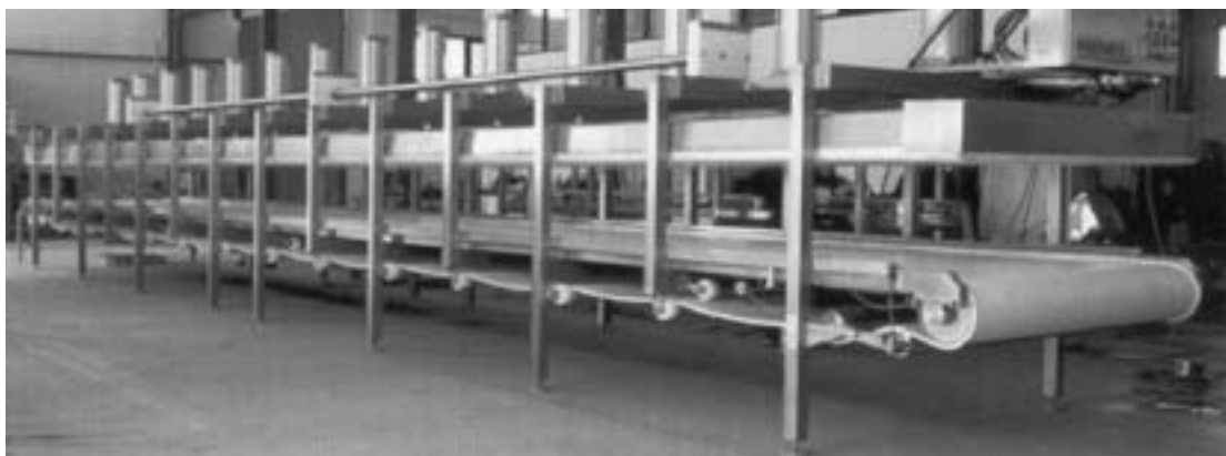
Figura 44. Premsa de matalàs (cortesia de Perinox, SA)
