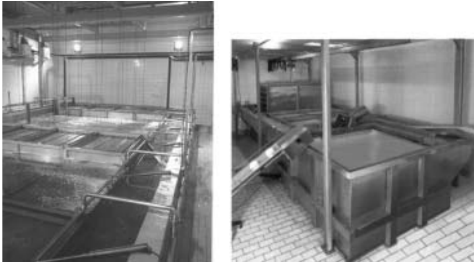
Figura 47. Saladors per immersió (cortesia de Perinox, SA)
