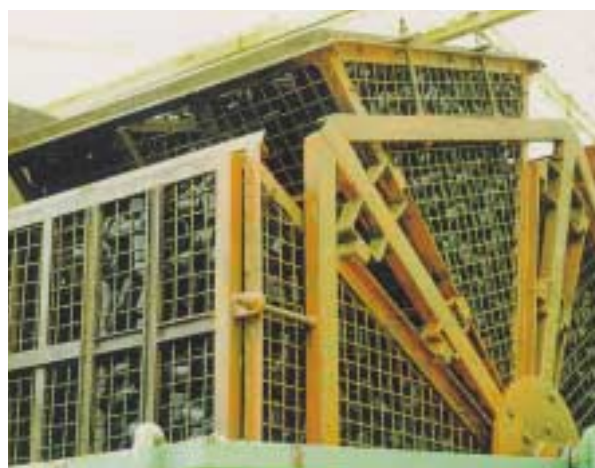
Sistema de bio-roda per transformar les oliasses en un líquid amb propietats fertilitzants
